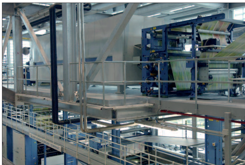
Le sécheur pour les publications sur papier couché (heatset).
