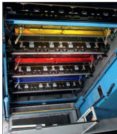
Vue sur l'encre simplifiée grâce au système anilox dans une tour d'impression.
